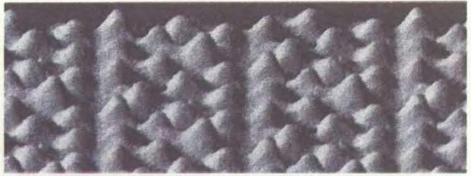
Микрофотография атомной поверхности кристалла кремния
